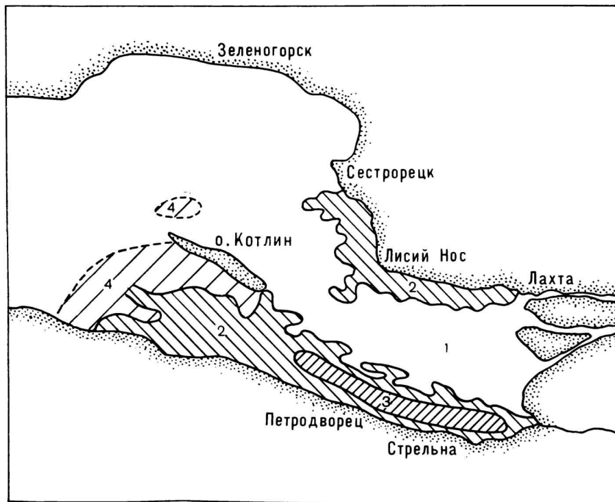
Рис. 9.14. Схема распределения зон с различным содержанием взвешенных частиц грунта в восточной части Финского залива (по результатам интерпретации изображений, полученных 27 сентября 1982 г. сканера МСУ-С ИСЗ „Метеор“).
