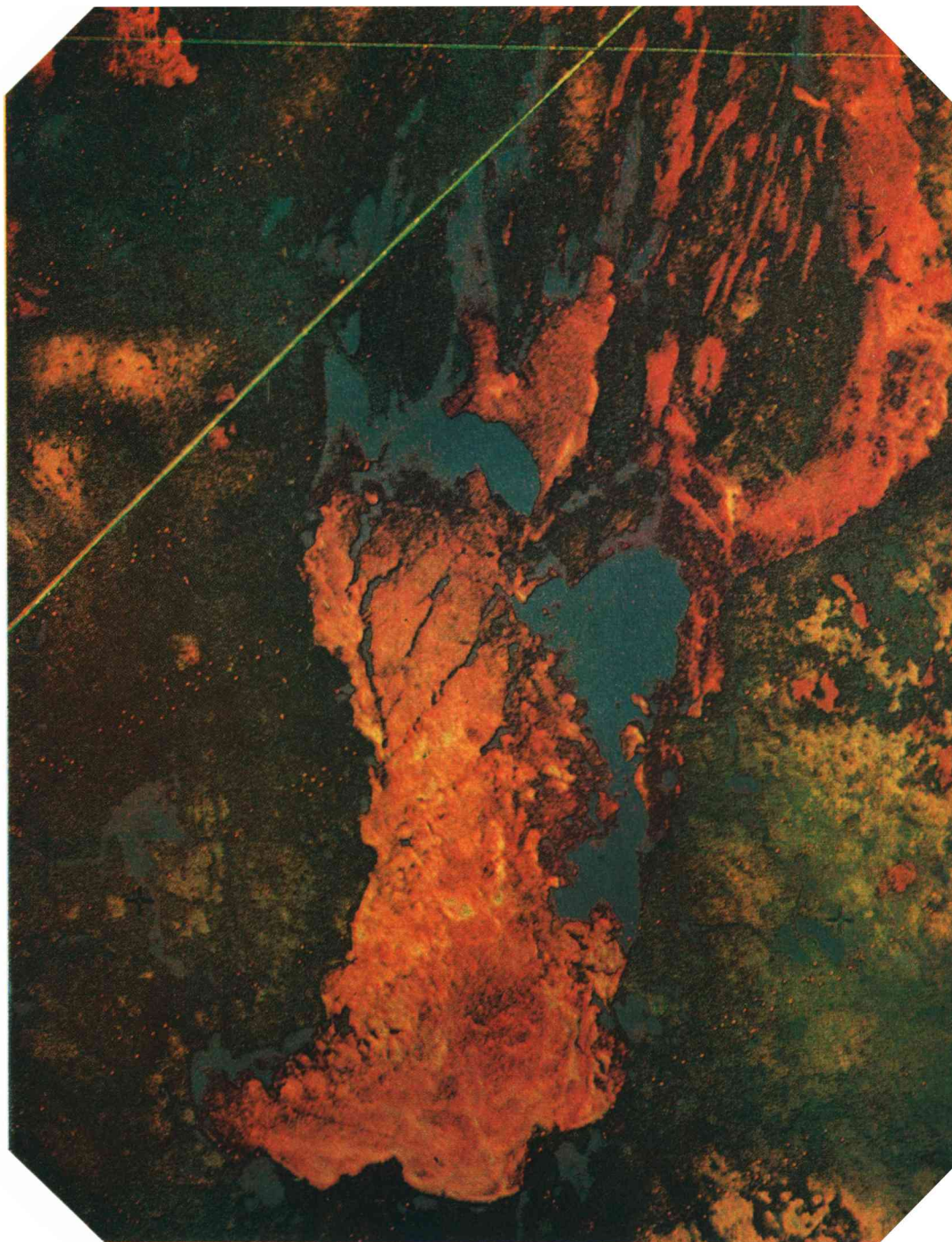
Рис. 8.7. Синтезированное изображение Онежского озера в период вскрытия, полученное на МСП-4 при использовании негативов и позитивов с ИСЗ „Метеор“ в двух диапазонах 0,5—0,6 и 0,7—1,1 мкм. 14 мая 1981 г.
