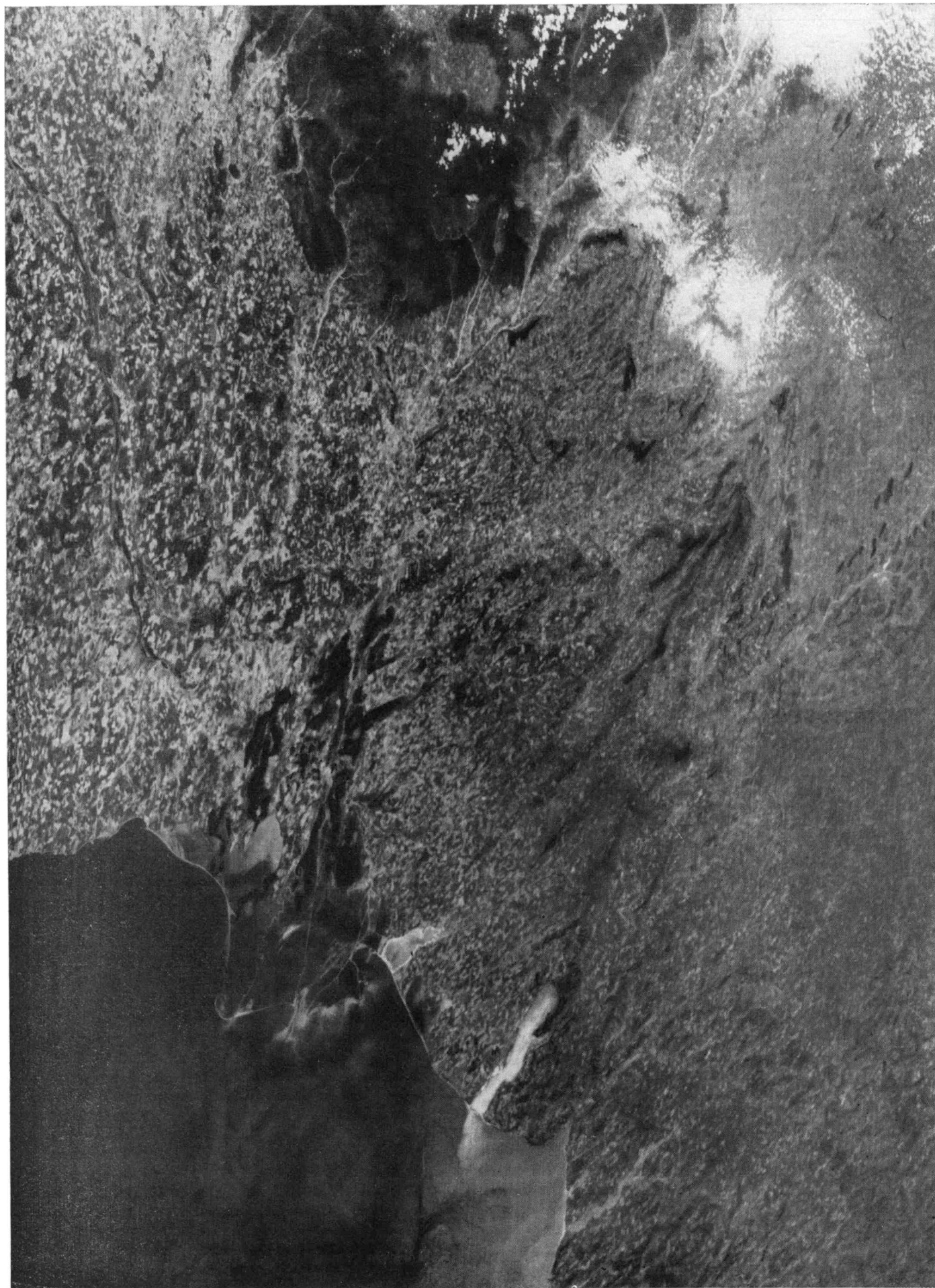
Рис. 3.12. Фрагмент изображения шириной 400 км в спектральном диапазоне 0,6—0,7 мкм, полученный с помощью МСУ-СК.
