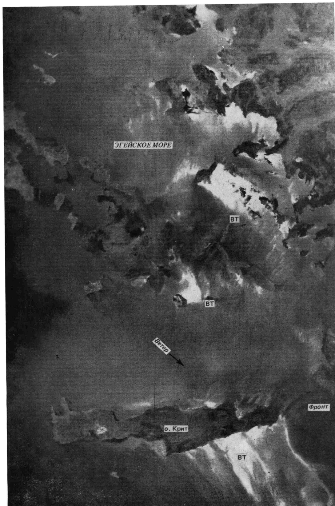
Рис. 9.8. Изображение участка поверхности Средиземного моря, полученное 26 июня 1980 г. со сканера МСУ-С (ИСЗ «Метеор», диапазон 0,5—0,7 мкм, виток 121, высота съемки 667 км, высота Солнца 61—65°).
