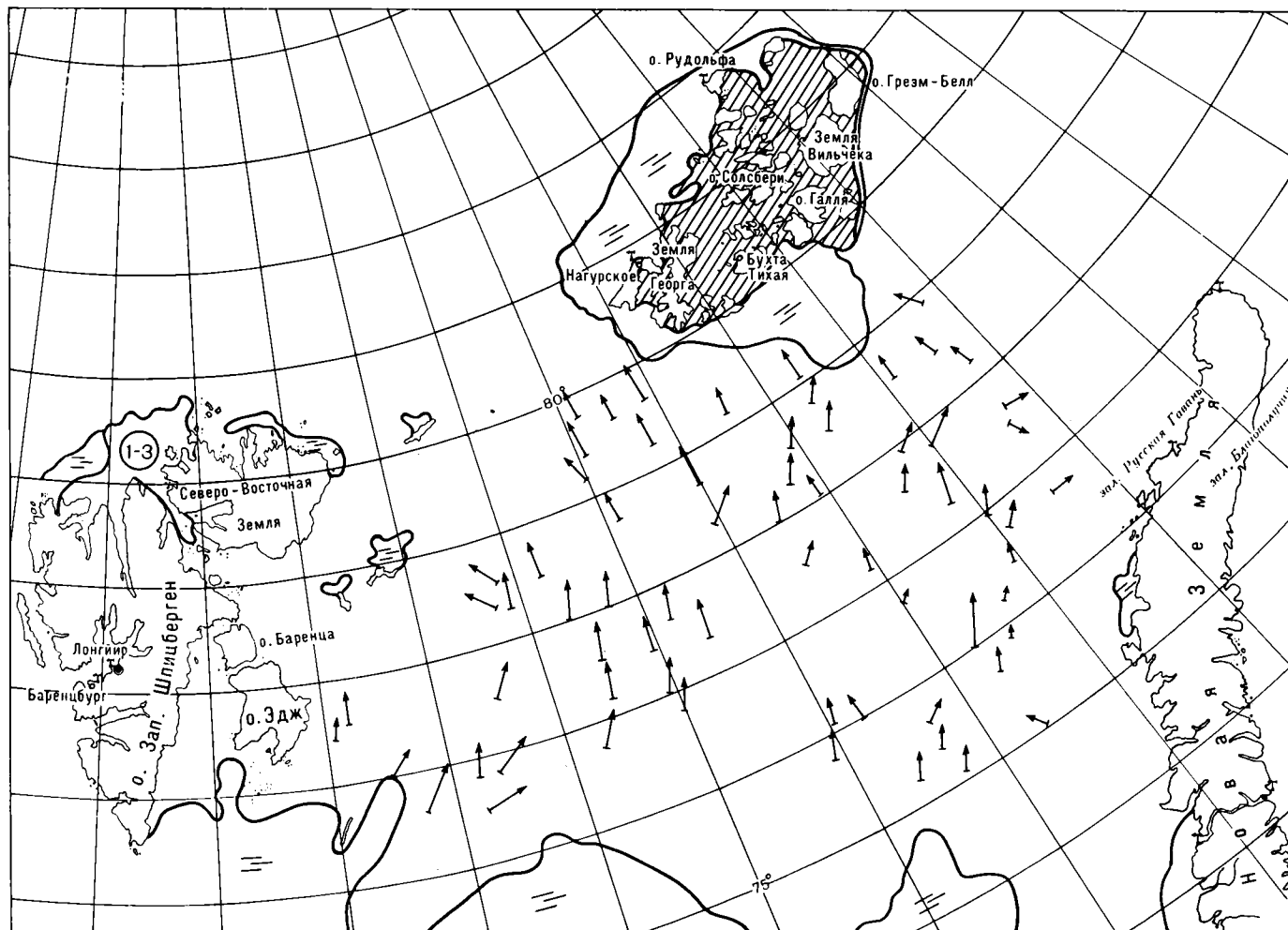
Рис. 9.5. Карта векторов дрейфа льда в западном секторе Арктики за период 12—17 июня 1981 г., полученная путем аналитической обработки изображений с ИСЗ «Метеор-2».
