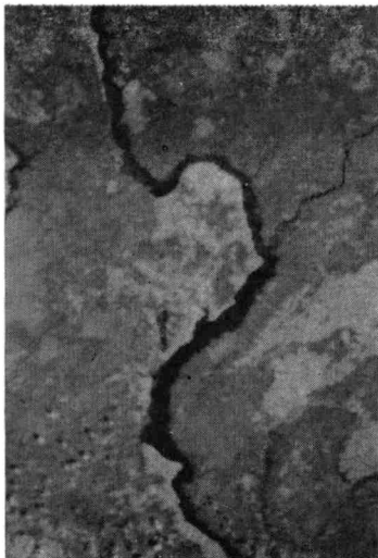
Рис. 8.14. ТВ изображение с ИСЗ «Метеор» (МСУ-С) разлива на р. Ветлуге. 19 мая 1981 г., диапазон 0,8—1,1 мкм.
