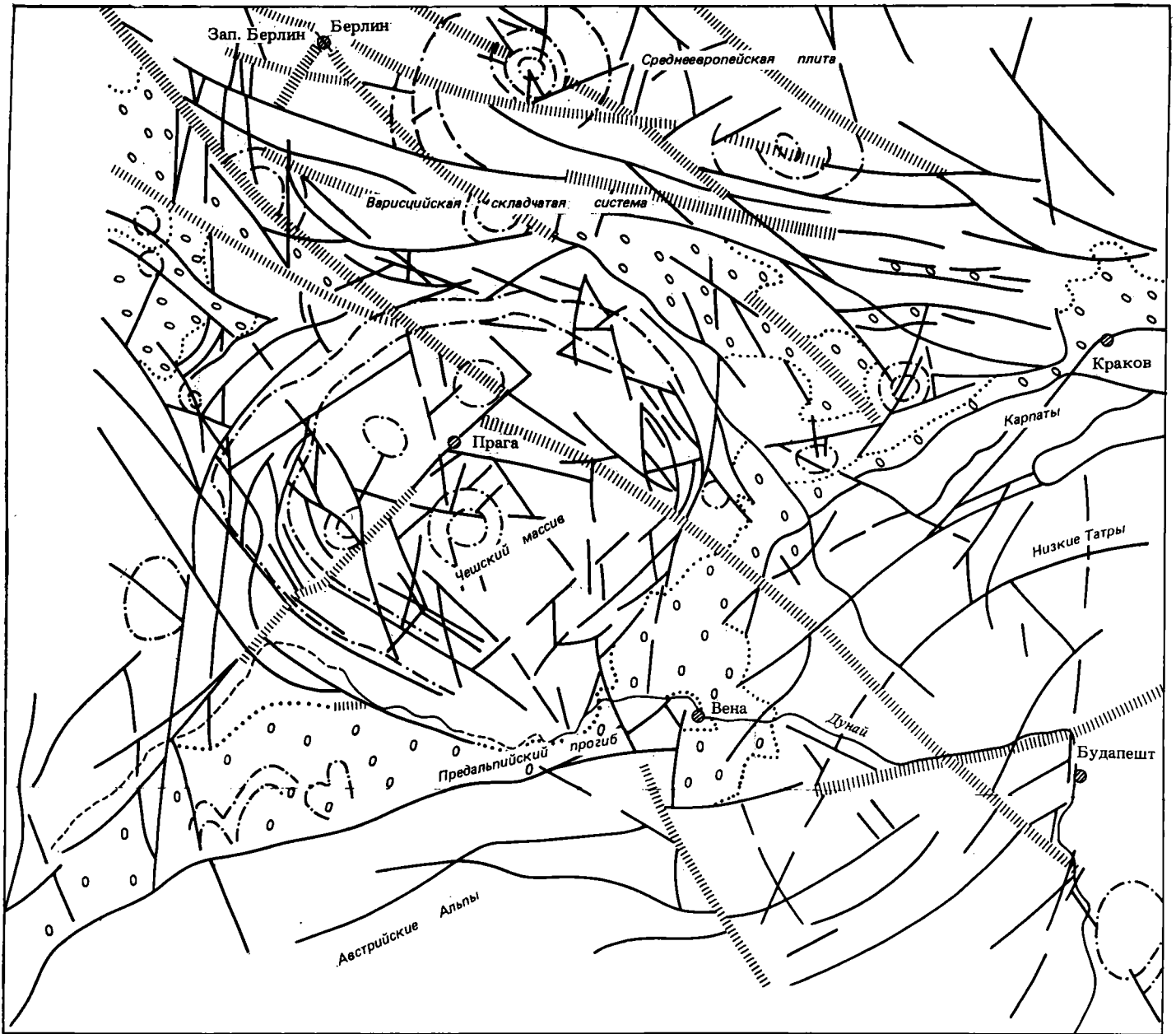
Рис. 11.10. Схема структурного дешифрирования района Чешского массива. 1 — разломы, 2 — линейные зоны, 3 — основные прогибы, 4 — кольцевые структуры.
