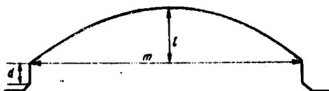
Рис.1. Профиль системы пленка Ge - подложка GaAs,  $d$  - толщина пленки.
